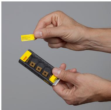
Wendeschneidplatten werden in Boxen mit getrennten Fächern geliefert. Dies erfolgt, um einen Kontakt mit den anderen Platten zu verhindern, der möglicherweise zur Beschädigung des Hartmetalls mit Mikrobruch und/oder zu Schneidenausbrüchen führt. Dadurch kann die Leistung und Standzeit der Wendeschneidplatte reduziert werden. Wendeschneidplatten sollten erst dann aus der Plattenbox genommen werden, wenn sie zum Einsatz kommen.
