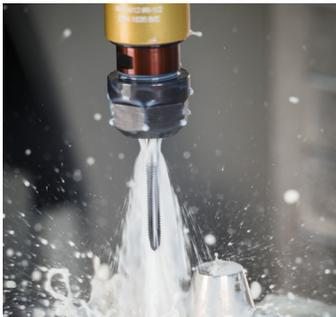
Die Kühlschmierstoffzufuhr ist entscheidend beim Gewindebohren und beeinflusst die
