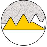
Eine Vollprofil-Wendeschneidplatte mit mehreren Zähnen reduziert die Anzahl der erforderlichen Zustellungen und bietet hohe Produktivität. So reduziert z. B. eine Mehrzahn-Wendeschneidplatte mit zwei Zähnen die Anzahl der Zustellungen um die Hälfte.
