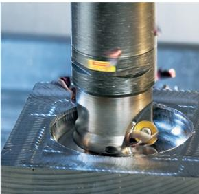
Ein Fräser kann anstelle von Bohr- oder Aufbohrwerkzeugen spiral- oder zirkularinterpolierend eingesetzt werden. Diese Methode ist weniger produktiv, aber eine Alternative bei Problemen mit Spanbruch.
