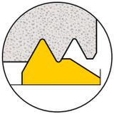
Das vollständige Gewinde wird von der Wendeschneidplatte hergestellt, wobei eine gute Kontrolle über die geometrischen Eigenschaften des Gewindes besteht, da der Abstand zwischen Gewindegrund und Spitze kontrolliert wird.
