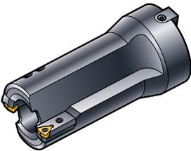
Das Kernbohren wird bei größeren Bohrungsdurchmessern und auf Maschinen mit begrenzter Leistung angewendet, weil es weniger Antriebsleistung als das Vollbohren benötigt. Kernbohrer sind in Durchmessern bis 110 mm (4.331 Zoll).
