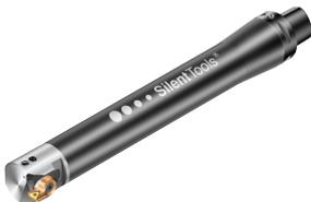
Silent Tools (schwingungsgedämpfte Aufbohrwerkzeuge) sind die erste Wahl bei Überhängen von mehr als 4 x Schaftdurchmesser.
