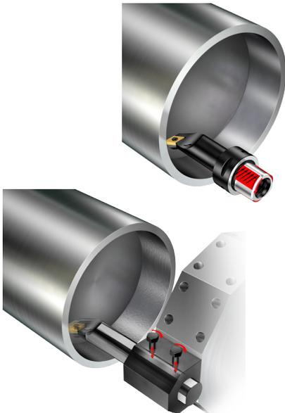
Bohrstangen werden häufig mit 2-3 Schrauben gespannt. Dies führt zu Vibrationsproblemen, schlechter Oberflächengüte, schnellem Plattenverschleiß sowie Produktionsunterbrechungen mit Nebenzeiten zur Anpassung der Schnittdaten und Werkstückmessung.
